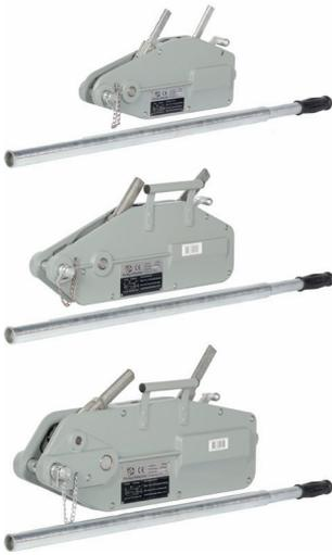
Das REMA Seilzug-Gerät ist ein äußerst robustes Werkzeug, das vertikal, horizontal und diagonal eingesetzt werden kann. Die Ziehkraft der verschiedenen Ausführungen beträgt 800 kg, 1600 kg oder 3200 kg. Sowohl der Bruchstift als auch der Hebel sind ausreichend stabil und schützen vor Überbelastung.
